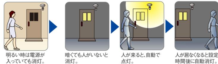
※センサーは人や車の様な動く熱源に反応します。※「昼」モード(1日中点灯モード)にすれば、明るい間も点灯します。設置する際のテストモードとしてご使用ください。
