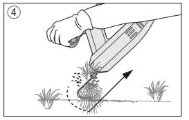
⑤抜いた草はブレードの振動で外れます。 また矢印の方向に振り草を外します。
