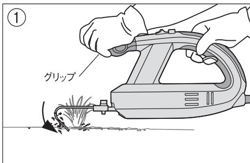
② ブレードを地に深く差し、矢印の方向にゆっくり突き刺します。
