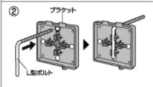
●ブラケットの内側から図のようにL型ボルトを通します。
