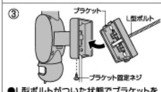
●L型ボルトが通った状態でブラケットをライト本体に取付け、ブラケット固定ネジをしっかりと締めます。
