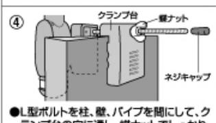
●L型ボルトを柱、壁、パイプに間に、クランプ台の穴に通し、蝶ナットでしっかり締めます。付属のネジキャップを取付けてください。
