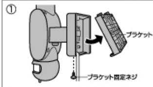
●ブラケット固定ネジをゆるめブラケットを外します。
