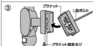
●L型ボルトがついた状態でブラケットをライト本体に取付け、ブラケット固定ネジをしっかりと締めます。
