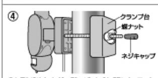
●L型ボルトを柱、壁、パイプに挿し、クランプ台の穴に通し、蝶ナットでしっかりと締めます。付属のネジキャップを取付けてください。
