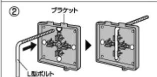
●ブラケットの内側から図のようにL型ボルトを通します。
