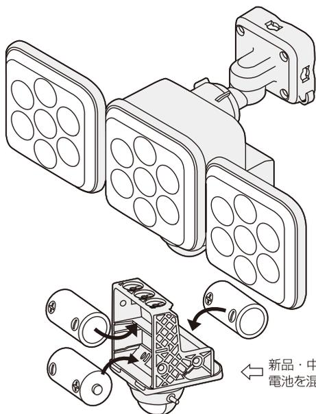
④ 爪を本体に引掛けてから電池ボックスを入れ電池ネジを締める。
