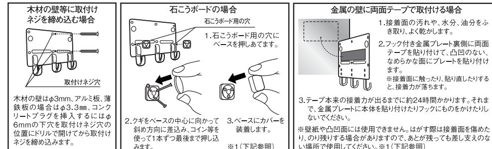
※1 本体を外すときはクギや両面テープが外れないように、フック付き金属プレートを手で押さえながら外してください。本体を頻繁にプレートから取り外す場合は、「木材の壁等に取付けネジを締め込む場合」を参照して取付けネジで木材の壁にプレートを取付けてください。
