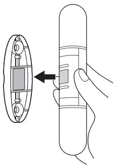
本体の電池蓋にある鉄板を左記の方法で取付けたマグネット台に貼り付けてください。
