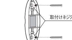
木材の壁はφ3mm、アルミ板、薄鉄板の場合はφ3.3mm、コンクリートプラグを挿入するにはφ6mmの下穴を取付けネジ穴の位置にドリルで開けてから取付けネジを締め込みます。
