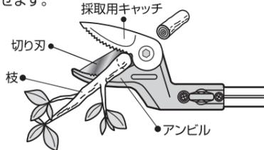
※図の採取用キャッチの裏側は枝はつかめません。パイプを回転させてキャッチを枝のつかみたい方向に向けます。
