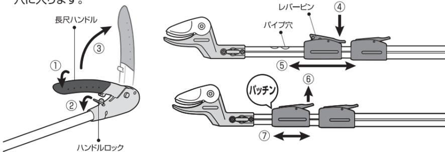
※注意 長尺ハンドルを開閉させても刃が動かない場合はレバーピンがパイプの穴に入っていないと⑥と⑦の調整を再度行なってください。
