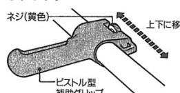
黄色のネジをゆるめ、お好みの位置に移動して再びネジをしめてください。
