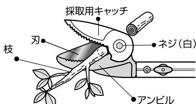
切り刃とキャッチの間に切りくずが挟まる場合があります。手袋を着用し、ハンドル部をロックして刃が開かない事を確認してから、キャッチだけを引っ張って、挟まった切りくずを掃除して下さい。
