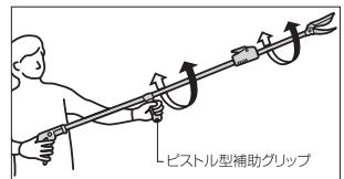
補助グリップの動きで刃先の向きがえられ、密集した枝でもラクにカットできます。
